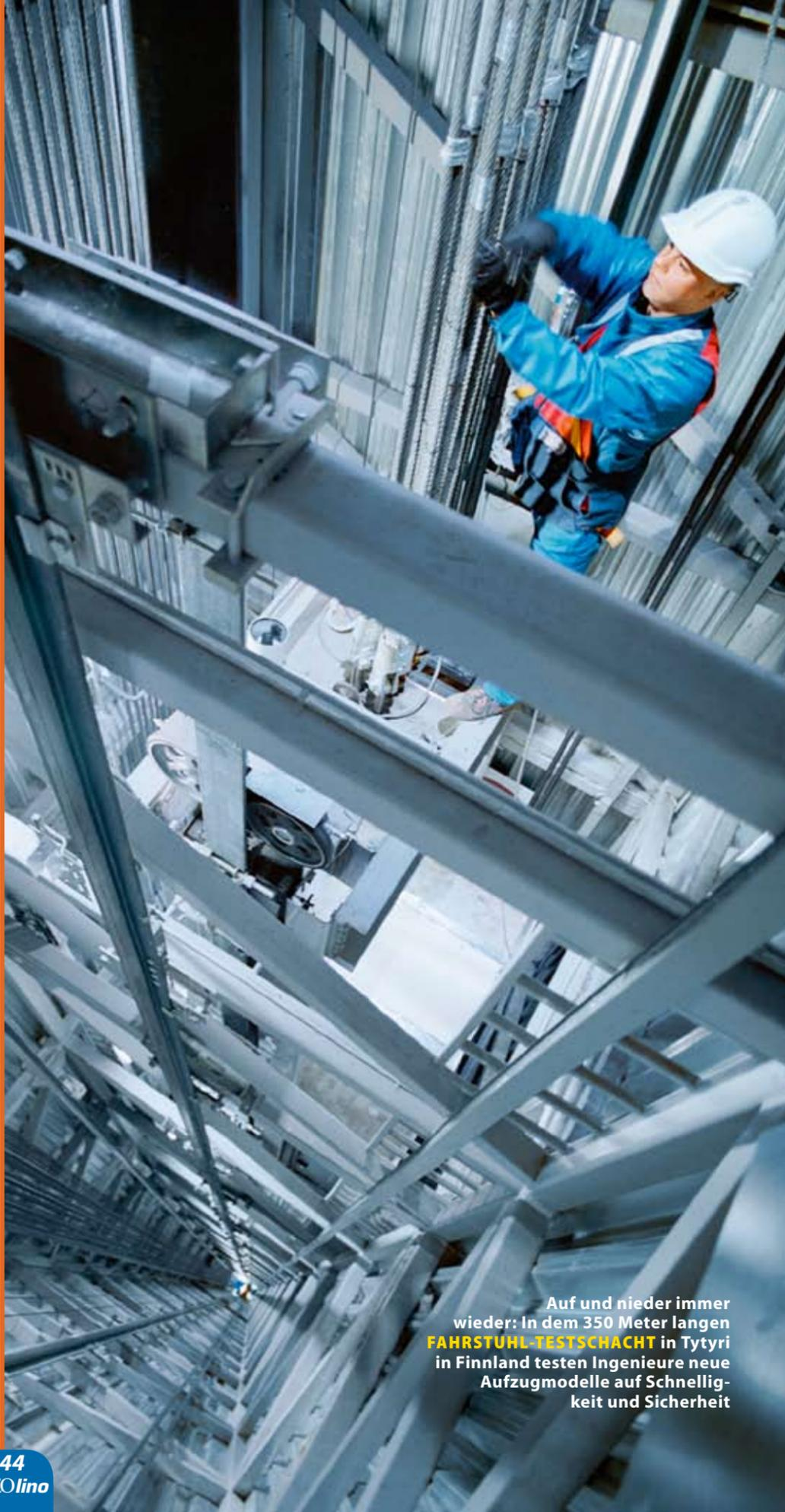
Auf und nieder immer wieder: In dem 350 Meter langen **FAHRSTUHL-TESTSCHACHT** in Tytyri in Finnland testen Ingenieure neue Aufzugmodelle auf Schnelligkeit und Sicherheit
